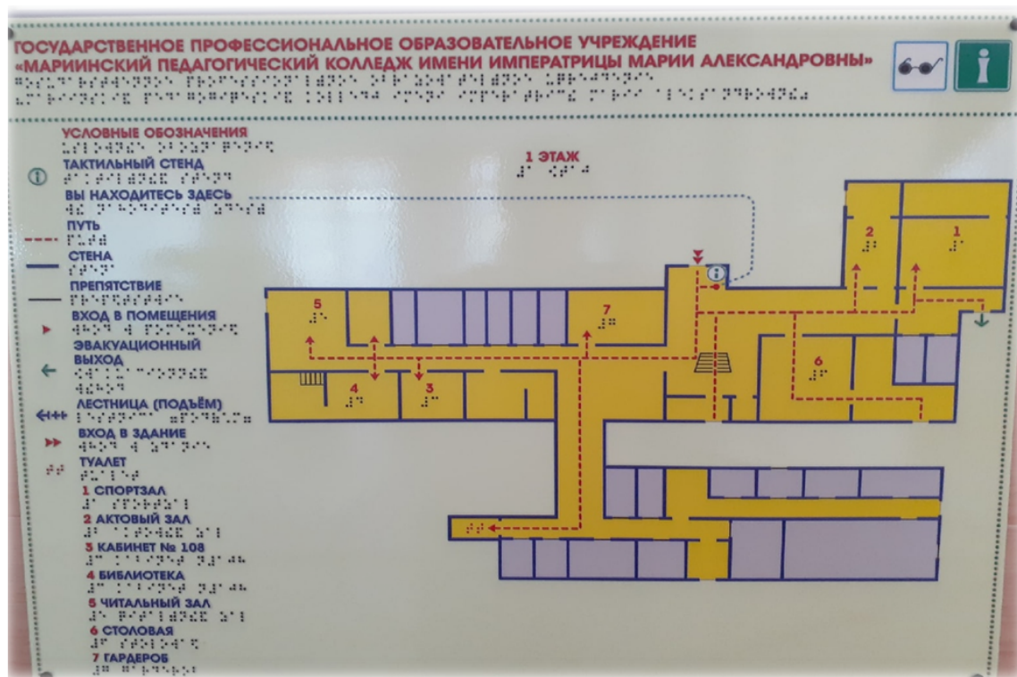
Фото 14- Тактильная фотолюминесцентная мнемосхема с азбукой Брайля 1 этажа
